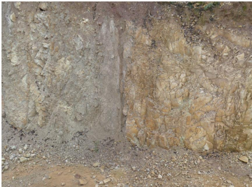
*Fig. 3.3 – Particolare della faglia sub-verticale (piazzale a quota 366 m.s.l.m.).*
