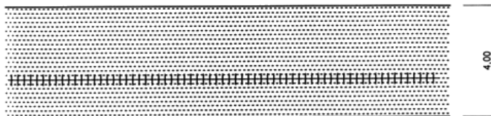
figura 1 scavo longitudinale alla carreggiata
