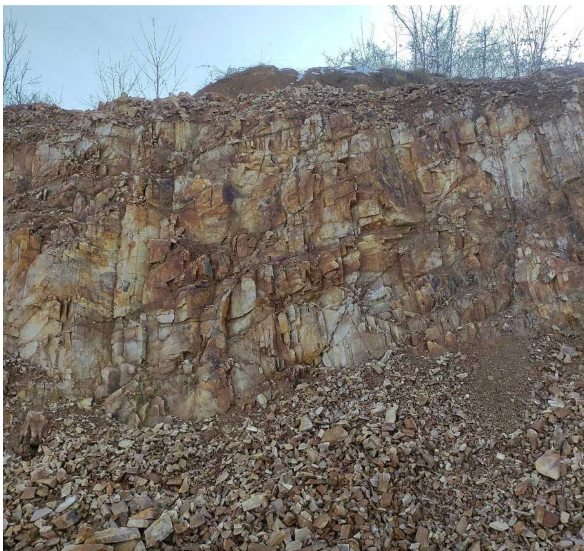
Figura 4 - Particolare di un fronte, in cui sono visibili le differenti varietà cromatiche, variabili dal grigio-giallo al rosso intenso, legate al diverso grado di alterazione della roccia.
